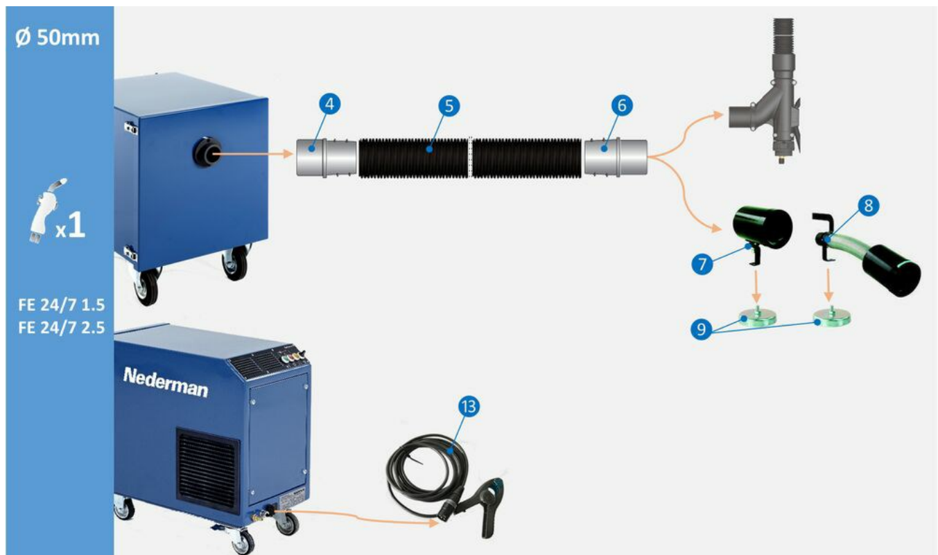
Tilbehørskonfiguration til en bruger, 50 mm tilslutning til svejseapparat. (4) Slangetilslutning M50-50P, art.nr. 55999416 (5) Slange PE-51 L=5 m, art.nr. 55999412 (6) Slangetilslutning F50-50P, art.nr. 55999417 (7) Dyse CWN-S 105/50 Lyddæmper, art.nr. 55999415 (8) Mundstykke CWN-S 105/50L, lyddæmper, art.nr. 55999414 (9) Magnetisk fod til mundstykke CWN-S, art.nr. 55999419 (13) Sensortang med stik til automatisk start/stop, art.nr. 55999410
